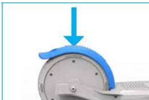
Ilustracja: Ustawianie programów jazdy przy pomocy kilku naciśnień hamulca nożnego
